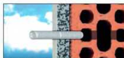
Prima di inserire la bussola retinata nel foro praticato, verificare la profondità del foro e tagliare, se necessario, sia la bussola che il tassello.
