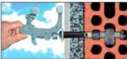
Introdurre il tassello ruotandolo leggermente sia a destra che a sinistra e spingerlo fino alla battuta della testa con la parete e posizionare nel punto esatto.
