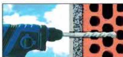
Forare la parete con una punta Ø18.
