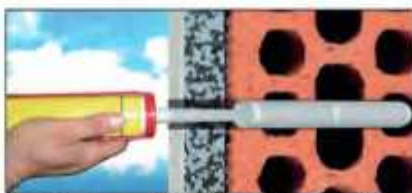
Immettere una quantità sufficiente di ancorante chimico nel foro della bussola già inserita.
