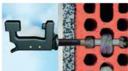
Si consiglia di avvitare l'accessorio sul tassello prima di inserirlo nel foro del muro così da rendere più semplice il suo posizionamento rispetto all'infilso e alla parete. Immettere anche un po' di ancorante chimico dentro il tubo forato del tassello.
