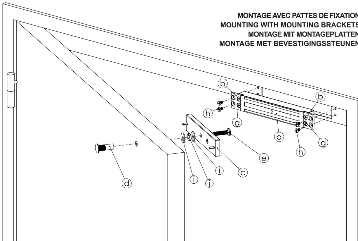
Insérer la rondelle caoutchouc (j) entre les rondelles métalliques (i) en évitant de serrer l'ensemble trop fortement afin de conserver la mobilité de la contreplaque.
